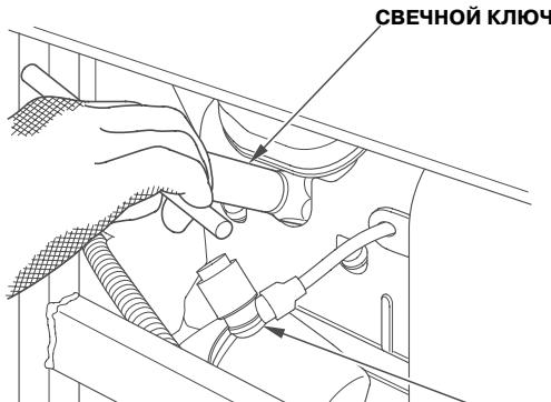
3. Осмотрите свечу зажигания. Замените свечу, если имеются следы износа на электродах или трещины, сколы или загрязнения на изоляторе.
