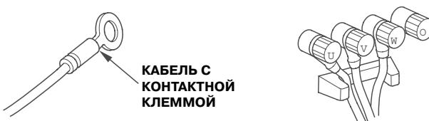
Проверьте правильность подключения клемм U-V-W. (При неправильном подключении электродвигатели и другое оборудование могут вращаться в обратном направлении.)
