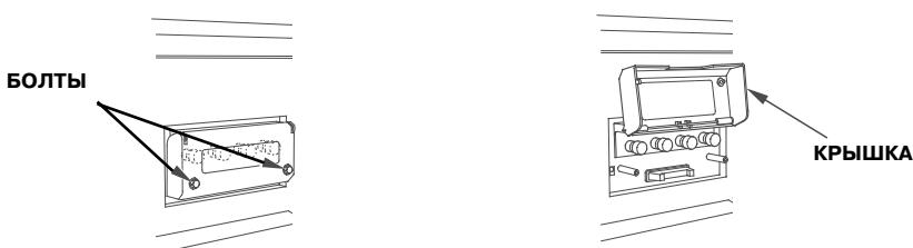
2. Соединительный кабель должен иметь контактную клемму. Подключите кабели к клеммам трехфазного тока как показано на рисунке.
