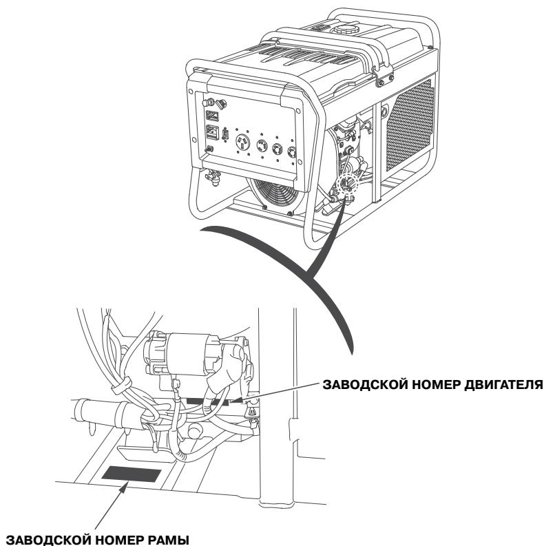
Запишите заводские номера двигателя и рамы в расположенные ниже строки. Вам потребуется указывать эти заводские номера при заказе запасных частей, а также при обращениях по техническим вопросам или в гарантийных случаях.
