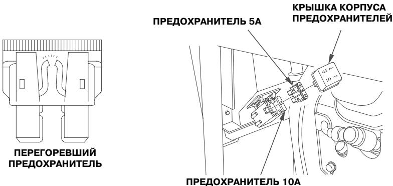
2. Снимите крышку корпуса предохранителей и замените предохранитель.
