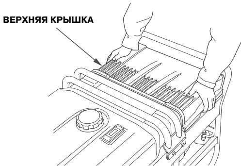
2. Отстегните четыре крепежные лапки от крышки воздушного фильтра и снимите крышку.
