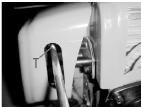
T = Винт регулировки холостого хода
