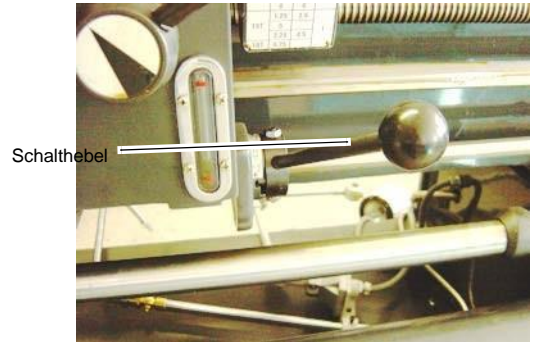
Рис. 4-3: Рукоятка переключения вращения шпинделя
