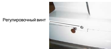
Рис.4-25: Смещение задней бабки
