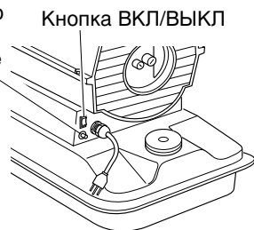
Рис. 5. Кнопка повторного зажигания для нагревателей мощностью 10 и 20 кВт
