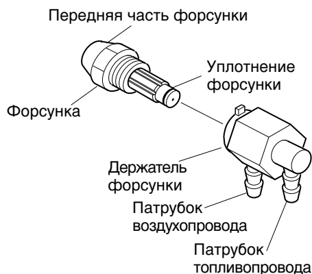
Рис. 22. Форсунка и держатель форсунки, нагреватель мощностью 10 кВт
