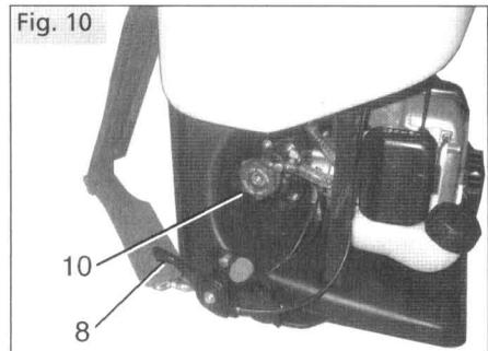
**Важно:** сначала установите обороты двигателя, затем положение регулятора давления. При работе обороты двигателя не должны быть низкими, не ниже  $\frac{3}{4}$  от максимума. При переходе от холостых оборотов к рабочим давление не должно быть высоким!
