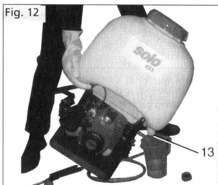
Опорожните бак для раствора, открутив крышку сливного отверстия (13). Наклоните прибор на сторону, чтобы полностью освободить бак. Двигатель должен быть остывшим. Промойте бак водой ежедневно после работы. После очистки оставьте бак открытым. Время от времени производите очистку водой с помощью щетки щетки горловины бака, фильтра и форсунки.
