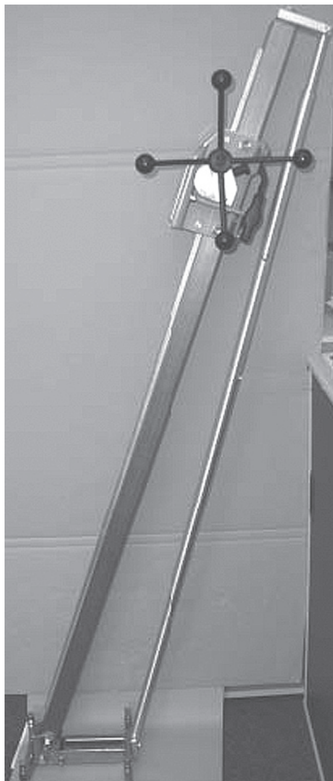
P-3000-Upi-дюб. подножка с колонной с ходом 1610 мм, колонна наклонена Рис. 3.22
