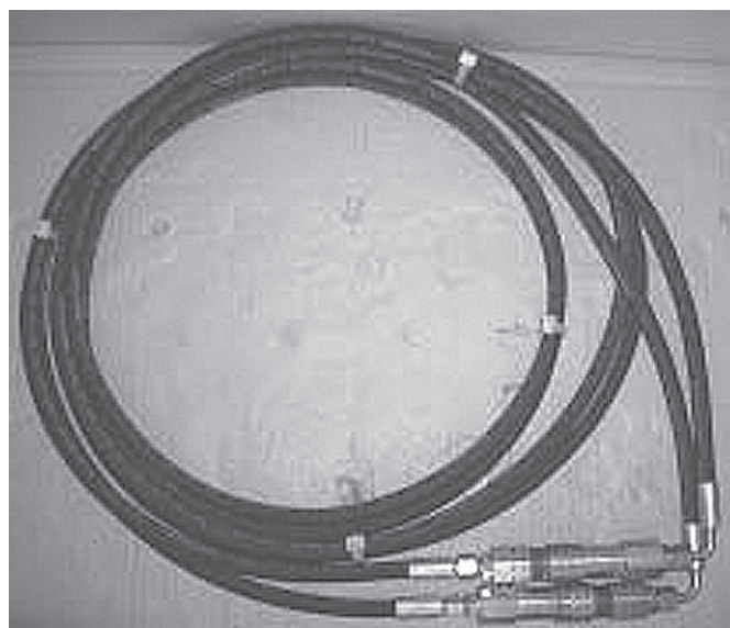
Hydraulikkupplungen der Hydraulikschläuche für Transport zusammengekuppelt Bild 3.71
