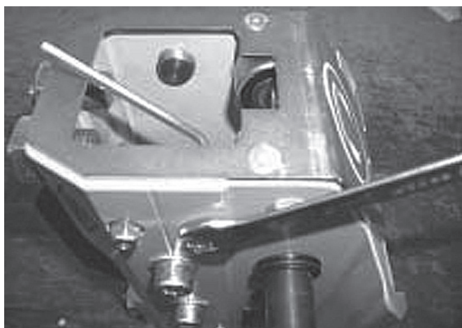
Р-3000-салазки (вид сверху), снятие верхней латунной пластины Рис. 7.9
