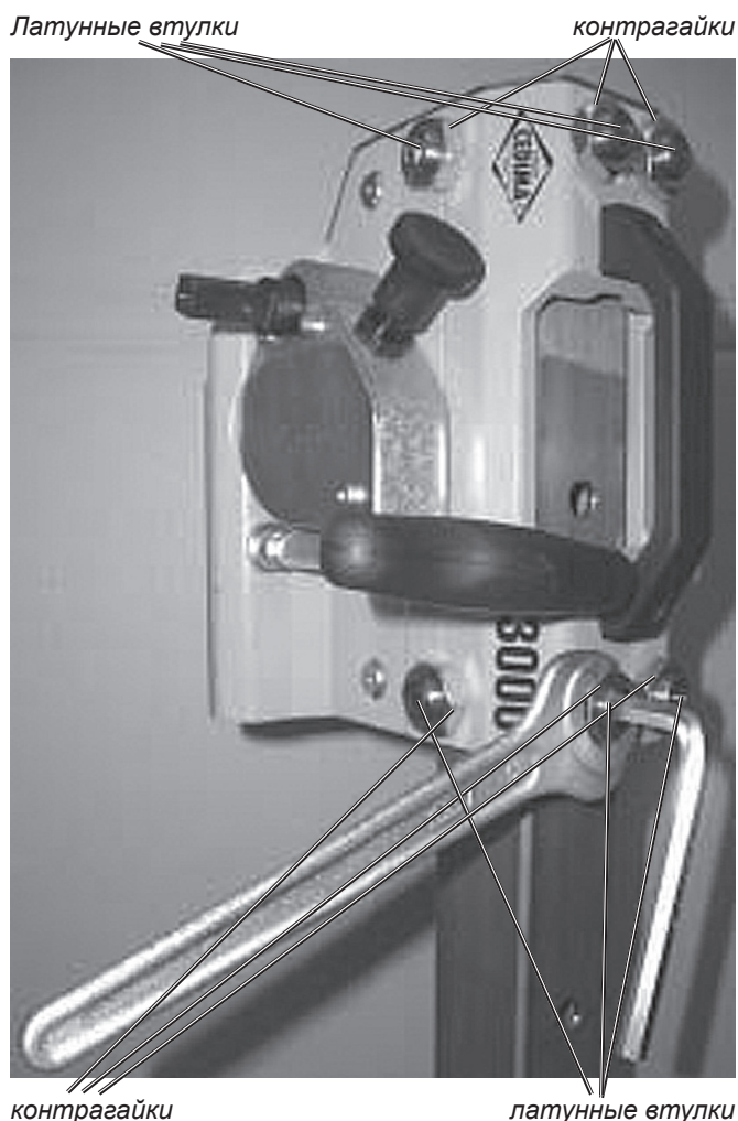
Регулировка сухарей (латунных втулок) на салазках Р-3000 (используются гаечный ключ SW 24 и шестигранный ключ SW 8) Рис. 7.1
