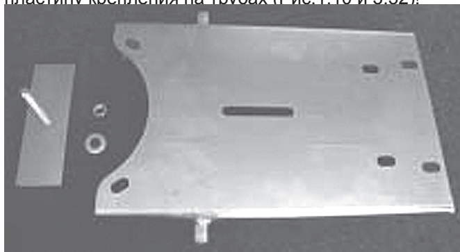
Пластина крепл. на трубах и соед. накладка с приваренным резьбовым стержнем, шайба, гайка Рис. 3.32
