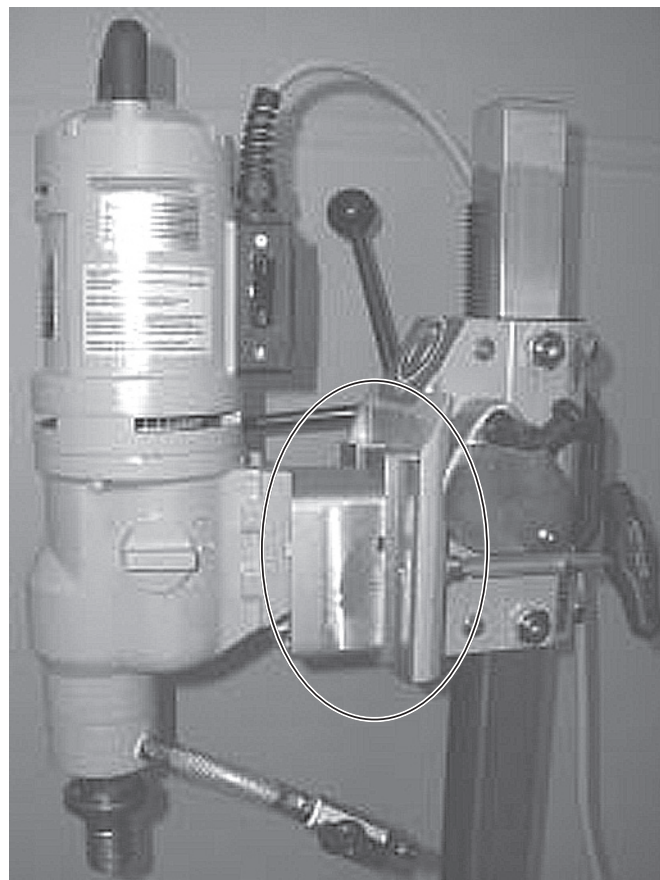
Мотор EM-3/4 с дистанц. плитой 4838 и монтажной пластиной тип С 4832 смонтированы на салазки P-3000 (поз. 1 для большой длины хода) Рис. 3.50
