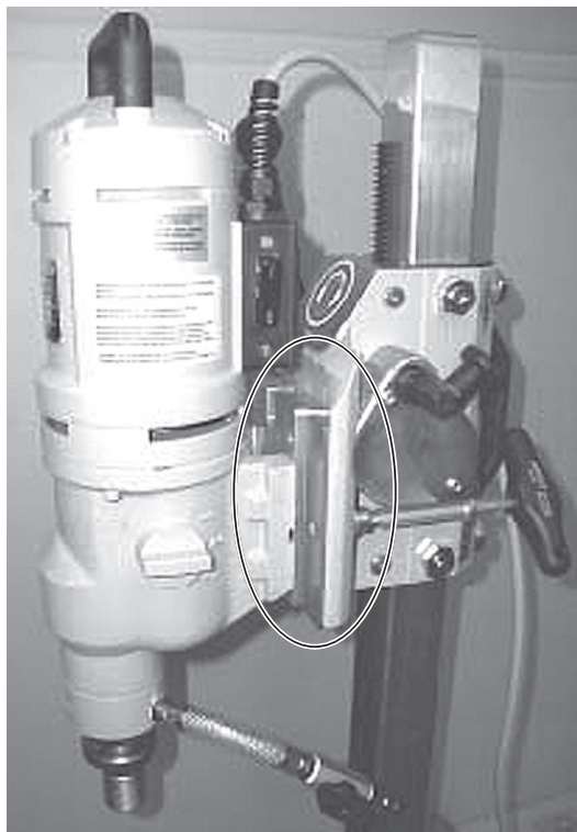
Мотор EM-3/4 с монтажной пластиной тип С, 4832 на салазки P-3000 смонтирован (поз. 2) Рис. 3.47
