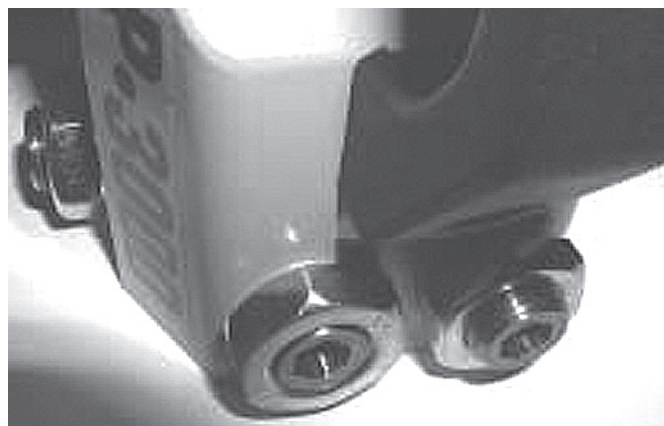
Регулируемые сухари (латунные втулки) на салазках Р-3000, левый достиг границы износа (заподлицо с контрагайкой) Рис. 7.1
