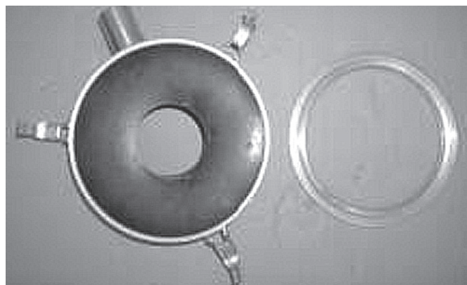
Уплотнит. кольцо (для коронок Ø 81 мм) надето на водосборное кольцо Рис.3.52
