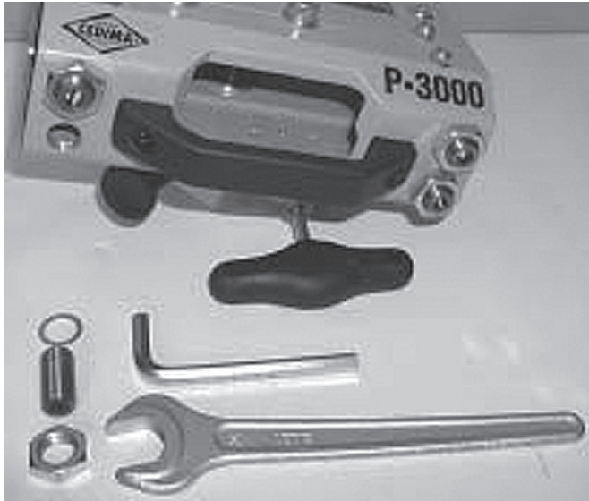
Регулируемый сухарь (латунная втулка с шайбой и контрагайкой) снят с салазок P-3000 (гаечный ключ SW 24 и шестигранный ключ SW 8)
