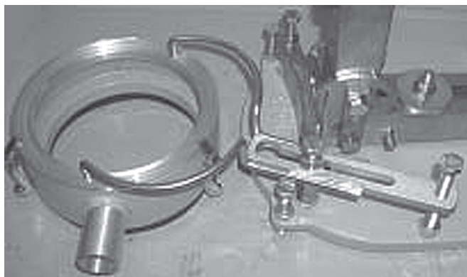
Водосборное кольцо с держателем на подножке P-3000-Uni смонтированы на вакуумной плите VP-150 Рис. 3.57
