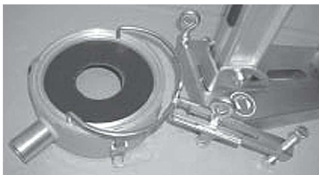
Водосборное кольцо с держат. смонтировано в подножке H-201-Uni (аналог P-3000) Рис. 3.58
