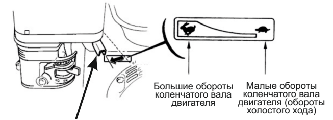
Рычаг управления дроссельной заслонкой
