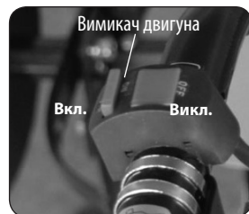
Вмикач двигуна знаходиться на ручці панелі оператора.
