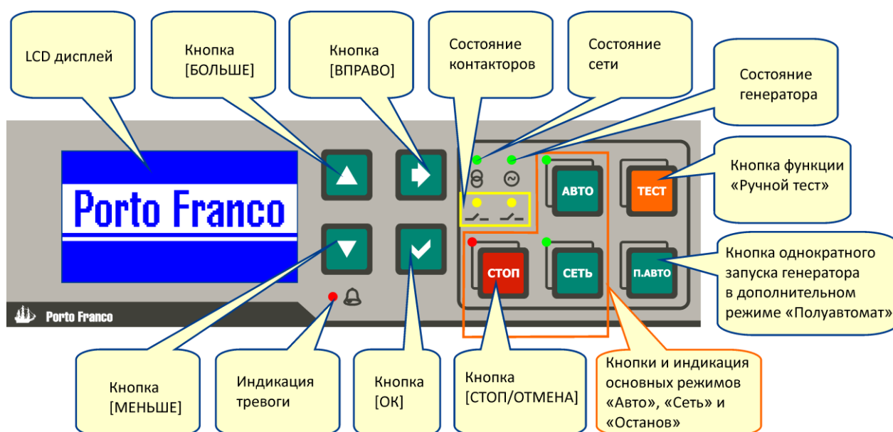
Рис. 5.2. Панель индикации и управления
