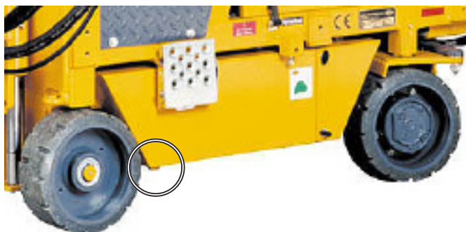
CF-6020 справа, Сливной винт на баке гидравл. жидкости Рис. 8.5
