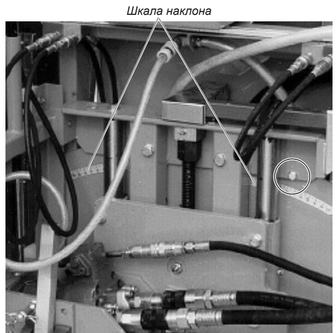
Винт для фиксации угла 90° режущей консоли
