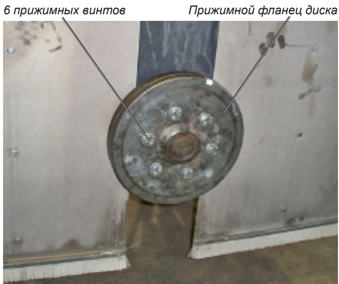
Крепление режущего диска (крышка кожуха диска откинута)
