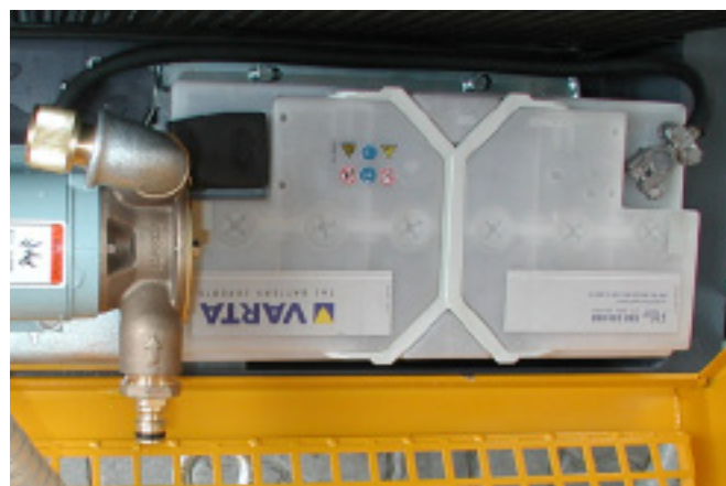
CF-6020, Аккумулятор стартера (капот открыт) Рис. 8.15
