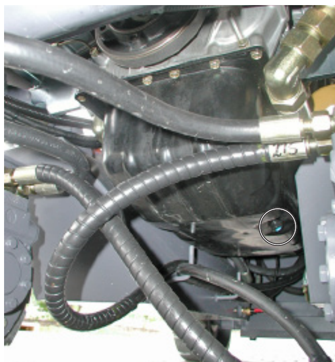
CF-6020 спереди, сливной винт моторного масла в поддоне моторного масла Рис. 8.21
