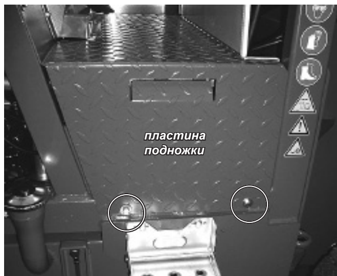
Место оператора справа, крепежные винты для защитной крышки подножки
