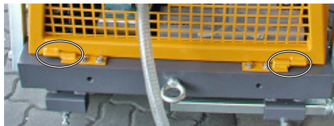
CF-6020 спереди, места смазки капота
