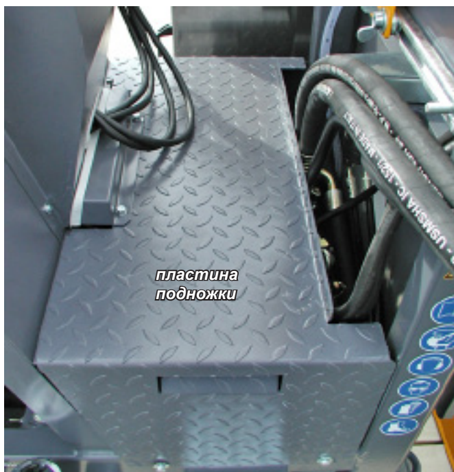
Снятие крышки (подножки) с пластины подножки Рис. 8.1
