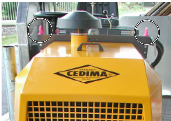
CF-6020, крановые проушины справа, слева на пульте управления (глушитель снят) Рис. 9.6
