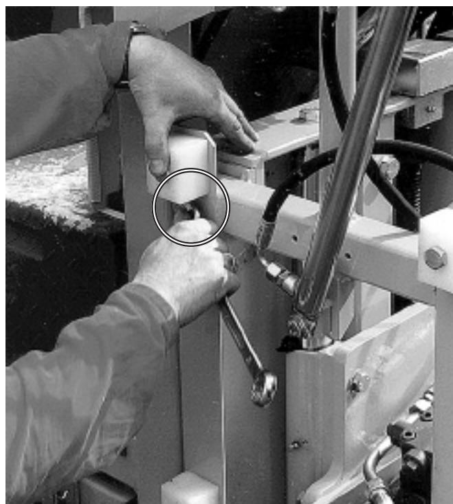
Снятие держателя защитного кожуха Рис. 7.3
