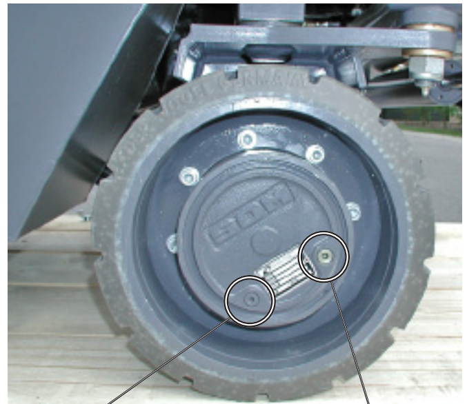
Сливной винт Контрольный, заправочный винт CF-6020, правое ведущее колесо
