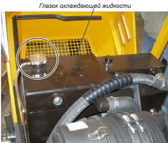
CF-6020, Радиатор охлаждающей жидкости и глазок Рис.5.5
