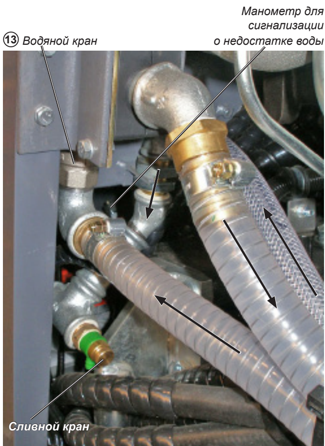
CF-6020 справа, подача воды между пультом и двигателем Рис. 5.16
