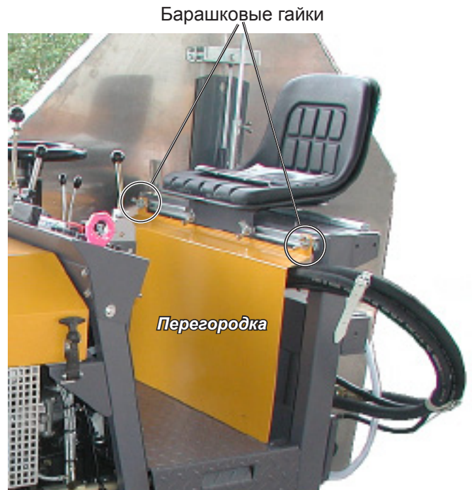
Перегородка на месте оператора (гидрошланги выходят слева для резки справа) Рис. 7.7
