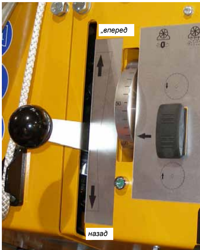
Рычаг подачи в среднем нейтр. положении Рис. 4.41
