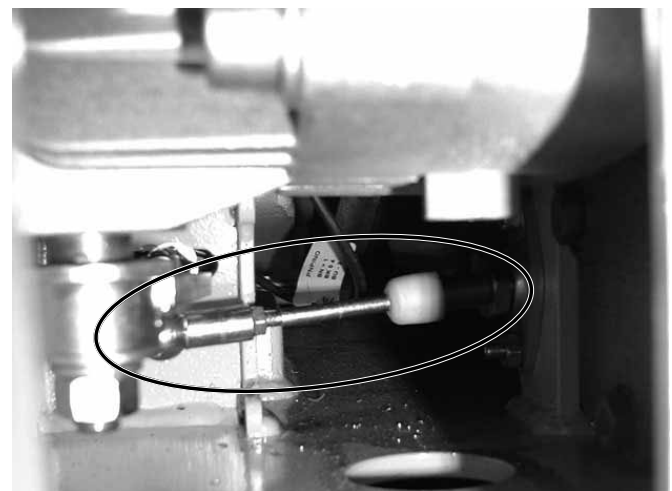
CF-3002 D-сзади (крышка снята) трос Бодена под гидростатическим приводом подачи, Рис. 6.12
