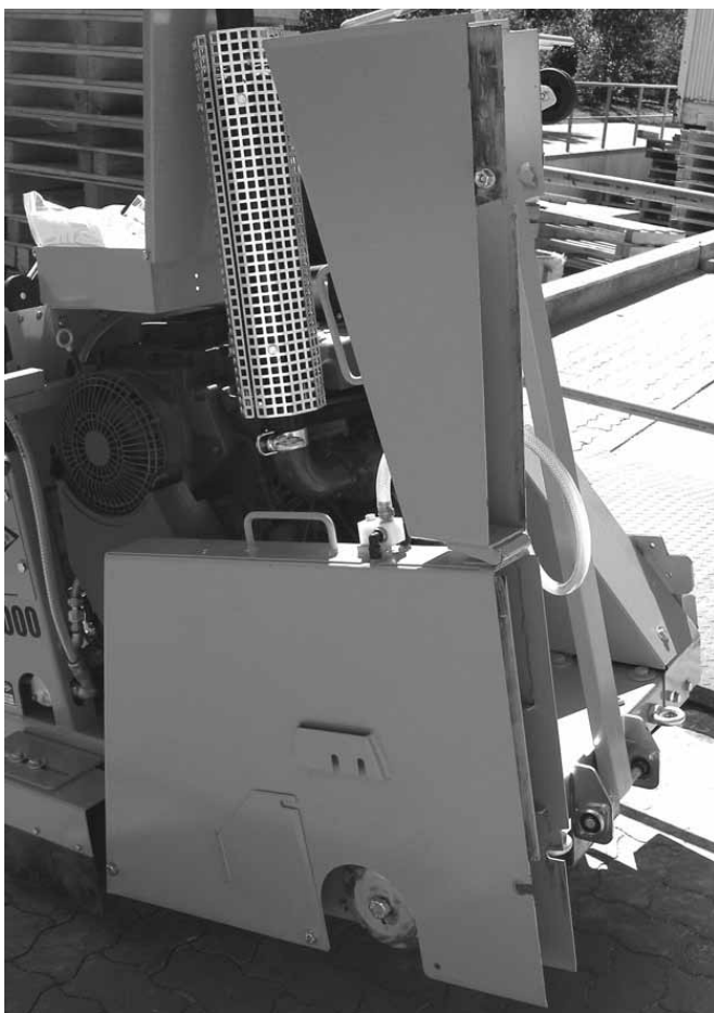
Защитный колпак откинут, (кожух диска смонтирован справа) Рис. 4.62
