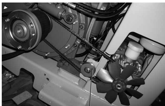
натяжной ролик ремня подачи
