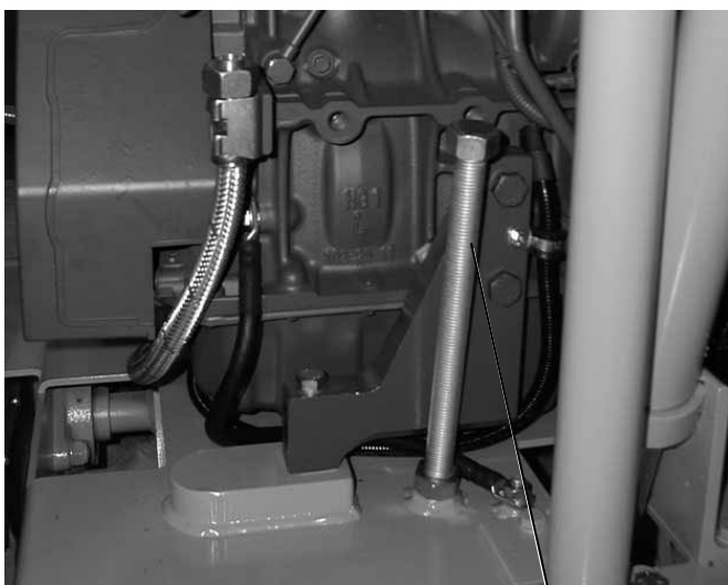
CF-3002 D спереди, винт упора глубины с контрагайкой (ограничитель опускания реж. вала) Рис. 4.46
