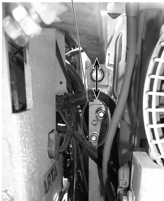
CF-3002D стандарт, винты для регулировки наклона рукояток
