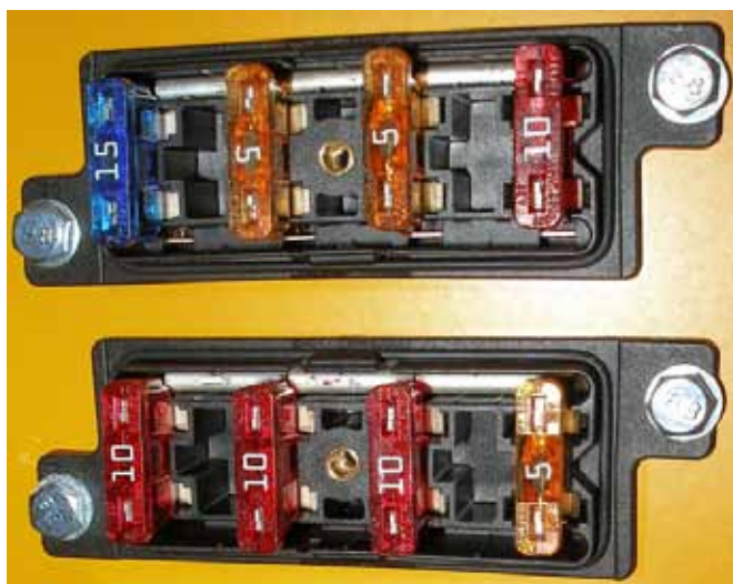
CF-3002 D Блок предохранителей (крышка снята) Рис. 6.19
