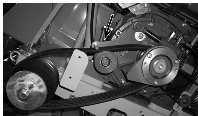
Сцепление режущего вала выключено (клиновые ремни вала ослаблены, кожух снят) Рис. 4.50
