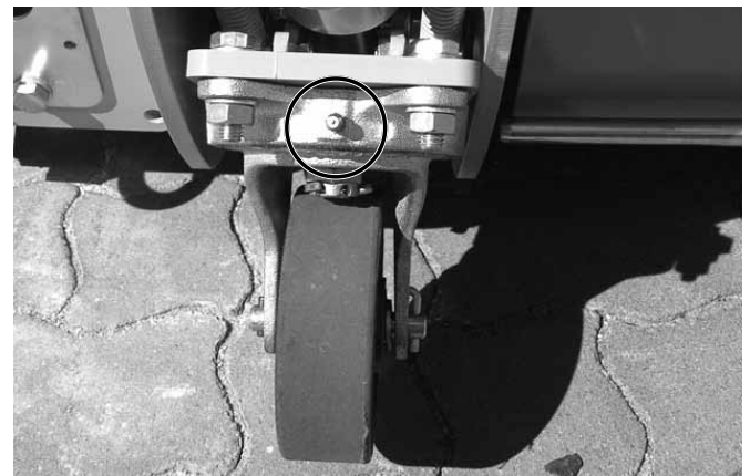
Место смазки на шарнире опорного колеса
