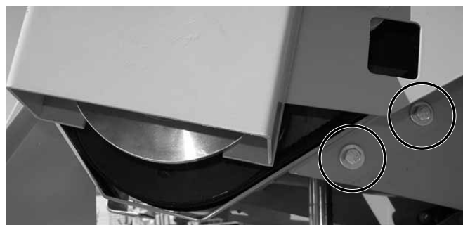
CF-3002D (слева), нижние винты, шайбы от направляющего лотка клиновых ремней Рис. 4.20
