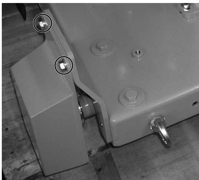
CF-3002 (стандарт), крышка крепления диска, режущего вала (смонтирована справа) Рис. 4.71
