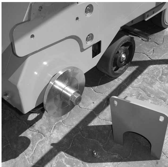
CF-3002D (слева), кожух вала снят Рис. 4.23
