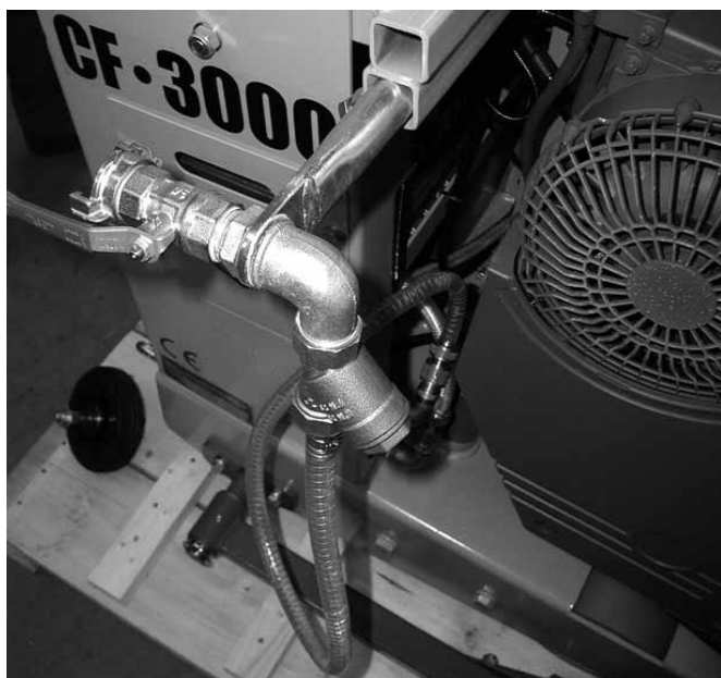
Разъем Гека подачи воды с запорным краном на выдвжной трубе Рис. 4.31
