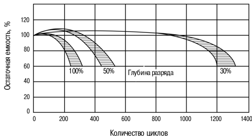
Рис. 8. Зависимость количества циклов от глубины разряда аккумуляторов
