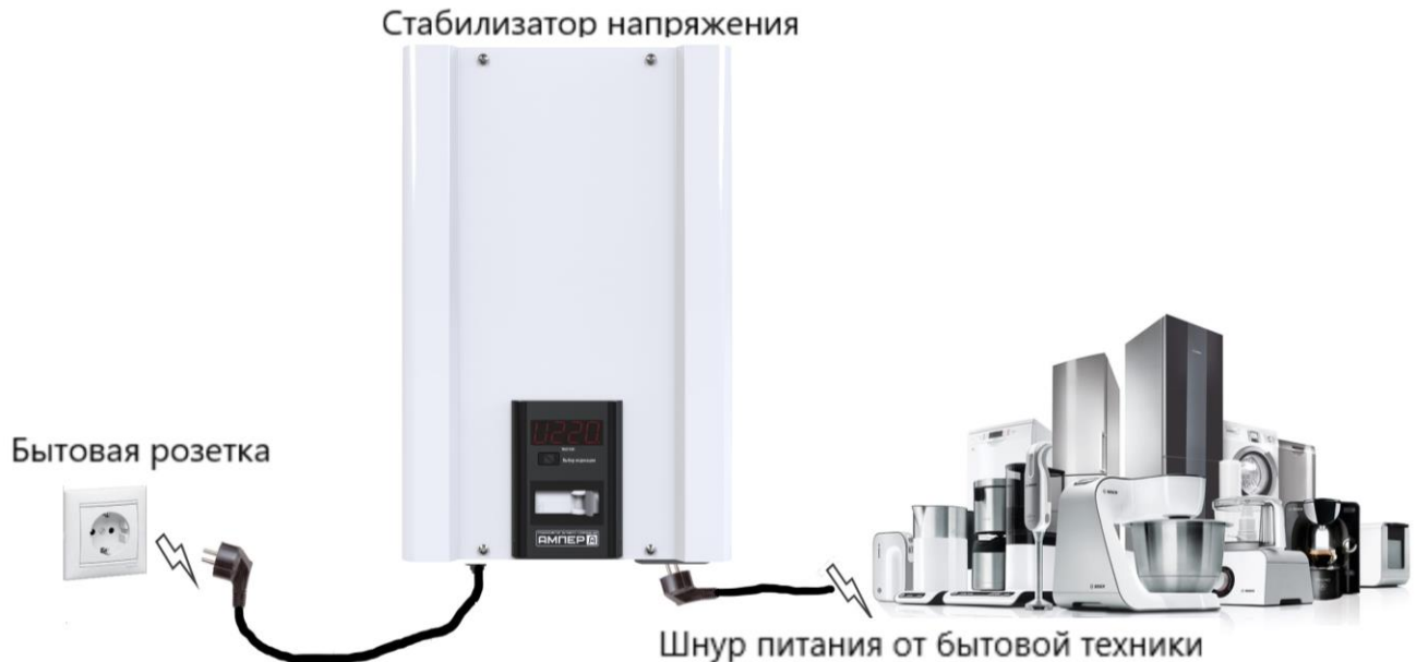
Рисунок 6. Подключение стабилизатора к сети
