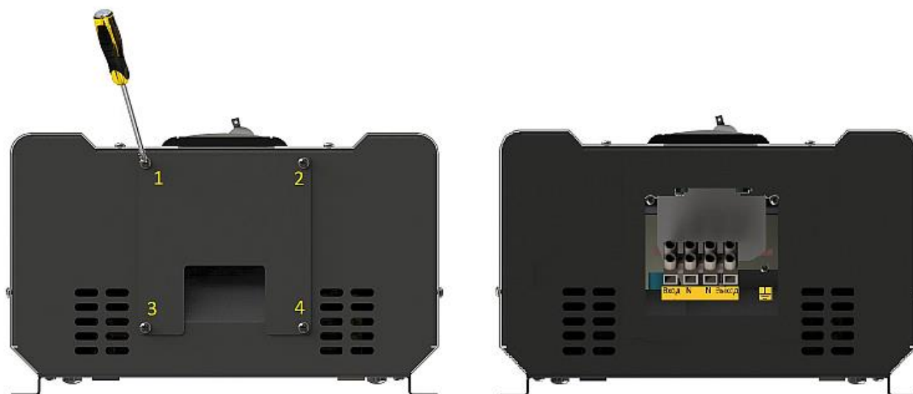
Рисунок 8. Схема снятия защитной крышки снизу корпуса стабилизатора
