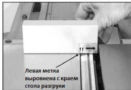
Рис. 23 (строгальный вал с прямым расположением ножей)
