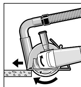
Включите электроинструмент и установите его передней частью направляющих салазок на деталь. Перемещайте электроинструмент с умеренной, соответствующей обрабатываемому материалу подачей.
