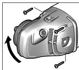
Il est possible de faire pivoter le carter d'engrenage par paliers de 90°. Ceci permet de mettre l'interrupteur Marche/Arrêt dans une position de maniement favorable à des utilisations spécifiques, p. ex. pour des travaux de tronçonnage effectués au moyen du carter d'aspiration avec glissière de guidage **18** ou pour les gauchers.
