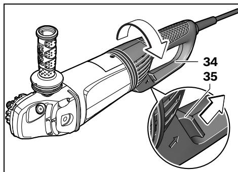
Головну рукоятку **34** можна повертати відповідно до корпуса мотора на 90° ліворуч або праворуч. Завдяки цьому вимикач буде знаходитися у більш зручному для певних видів роботи положенні, напр., при роботі з витяжним ковпаком з направляючою шиною **18** або якщо Ви лівша.
