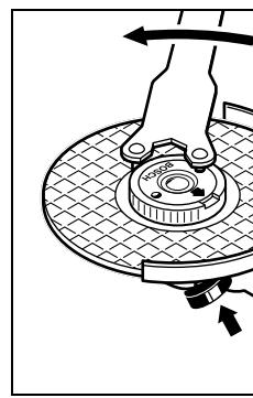
Правильно закрепленную, не имеющую повреждений быстрозажимную гайку Вы можете отвернуть, вращая рукой кольцо с накаткой против часовой стрелки.
