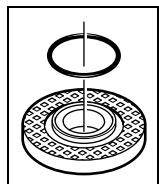
На опорном фланце **5** вокруг центрирующего буртика находится пластмассовая деталь (кольцо круглого сечения). **Если кольцо круглого сечения отсутствует или повреждено**, опорный фланец **5** необходимо обязательно заменить перед дальнейшим применением.
