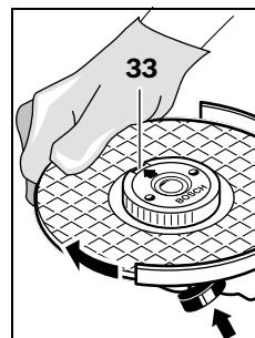
Для фиксирования шлифовального шпинделя нажмите кнопку фиксации шпинделя 1. Для затягивания быстрозажимной гайки поверните шлифовальный круг с усилием по часовой стрелке.
