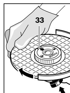
Натисніть на фіксатор шпинделя **1**, щоб зупинити шліфувальний шпиндель. Для затягнення швидкозатискої гайки з силою поверніть шліфувальний круг за стрілкою годинника.
