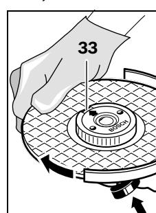
Afin de bloquer la broche d' entraînement, appuyez sur le dispositif de blocage de la broche 1. Afin de serrer l'écrou de serrage rapide, tournez fortement la meule dans le sens des aiguilles d'une montre.
