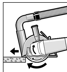
Elektrikli el aletini çalıştırın ve kilavuz kızığın ön kısmını iş parçası üzerine yerleştirin. Elektrikli el aletini makul ve işlenen malzemeye uygun bir bastırma kuvveti ile hareket ettirin.
