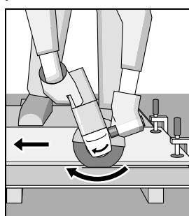
Elektrikli el aleti daima dönmeye yönünün tersine yönlendirilmelidir. Aksi takdirde alet **kontrol-dan** ve kesme hattından çıkabilir.
