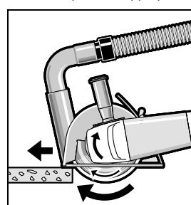
Mettez l'outil électroportatif en marche et positionnez-le avec la partie avant de la glissière de guidage sur la pièce à travailler. Travaillez en appliquant une vitesse d'avance modérée adaptée au matériau.
