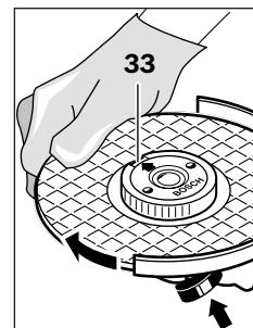
یک مهاره مهار سریع (مهره SDS) بدون نقص که به درستی مکم شده است، را میتوانید بواسیله دست از طریق چرخش حلقه شیاردار آن، در خلاف جهت حرکت عقربه ساعت باز کنید.
