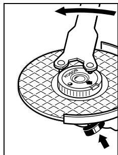
Закріплену належним чином, непошкодженню швидкозатиску гайку можна відпустити, вручну повертуючи кільце з накаткою проти стрілки годинника.
