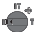
Pozycja do Wiercenia bez udaru w drewnie, metalu, ceramice i tworzywie sztucznym, a także do wkręcania śrub
