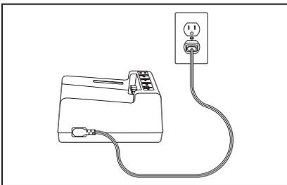
Use solo el cable suministrado con el cargador. Al usarlo por primera vez, verifique que el tipo de enchufe es compatible con el receptáculo.
