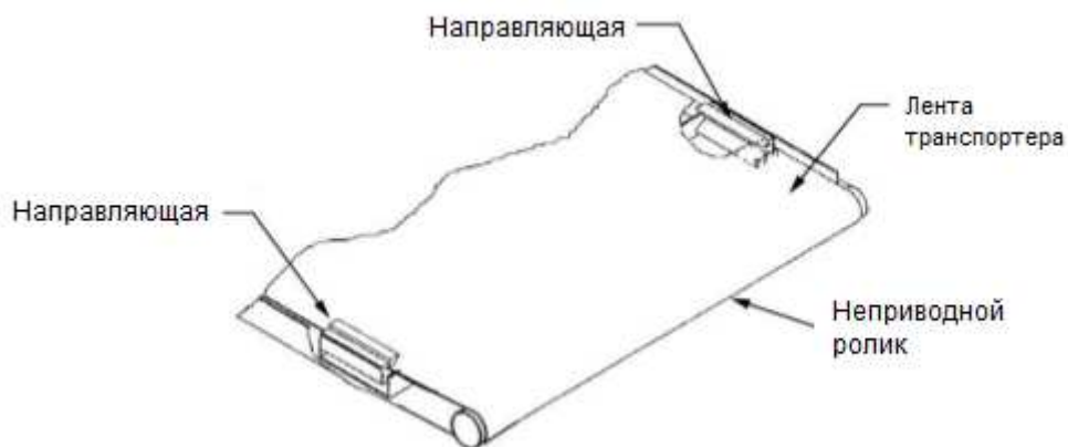
Рис. 22 – Показана обратная сторона транспортера
