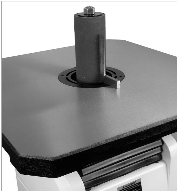
Рис. 13: настройка упора наклона стола
