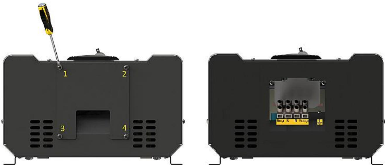
Рисунок 8. Схема зняття захисної кришки знизу корпусу стабілізатора
