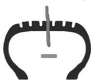
Неправильне встановлення джгута
