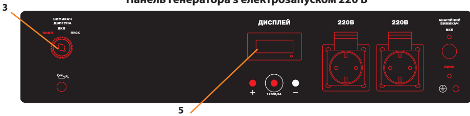
Панель генератора з електрозапуском 220 В та ATS
