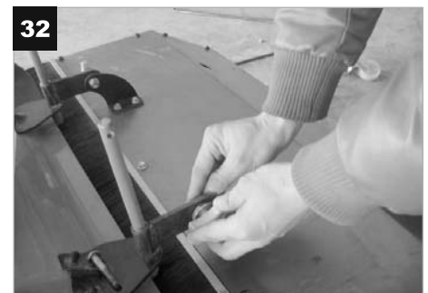
Fix the dust collector to machine by bolts and knobs / Закріпіть пилозбірник на машині за допомогою болтів і ручки на адаптері / Připevňte zásobník pomocí šroubů a matic na stroj / Připevnte zásobník pomocou šroubů a matic na stroj / Zamocować podajnik pomocą śrub do maszyny
