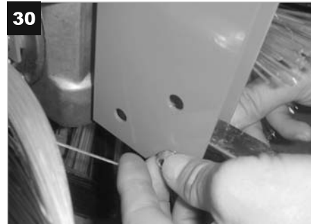
Fix the other support pillar to the machine by bolt / Закріпіть нижню опорну стійку до машини болтами / Připevňte spodní podpěru pomocí šroubů ke stroji / Připevňte spodní podporu pomocí šroubů ke stroji / Zamocować dolny nośnik pomocą śrub do maszyny
