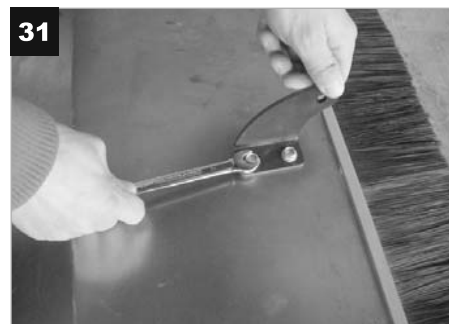
Fix two holders to the dust collector by bolts / Закріпіть два тримачі до пилозбірника болтами / Připevňte dva držáky pomocí šroubů k zásobníku / Připevnte dva držáky pomocou šroubů k zásobníku / Zamocować dwa wsporniki pomocą śrub
