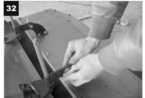
Fix the dust collector to machine by bolts and knobs / Закріпіть пилозбірник на машині за допомогою болтів і ручки на адаптері / Připevňte zásobník pomocí šroubů a matic na stroj / Připevnte zásobník pomocou skrutiek a matic na stroj / Zamocować podajnik pomocą śrub do maszyny
