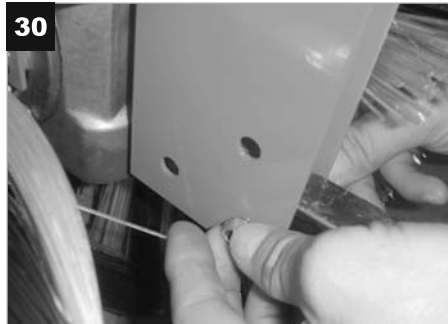
Fix the other support pillar to the machine by bolt / Закріпіть нижню опорну стійку до машини болтами / Připevňte spodní podporu pomocí šroubů ke stroji / Připevňte spodní podporu pomocí šroubů ke stroji / Zamocować dolny nośnik pomocą śrub do maszyny
