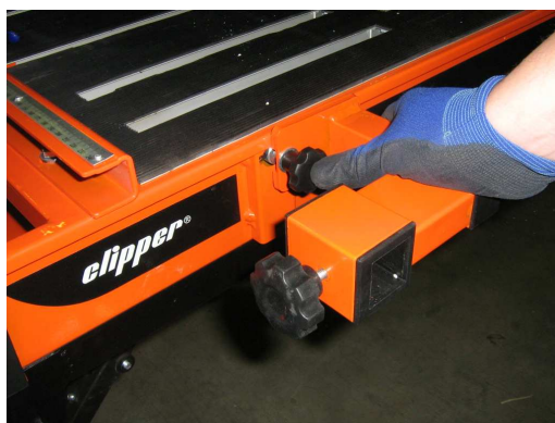
Вставьте два резьбовых валика
