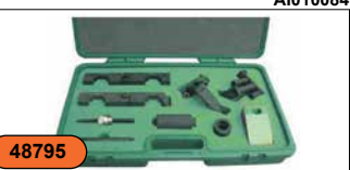
Набор для регулировки ГРМ VANOS двигателей BMW V8 M60/M62/M54 AI010084
