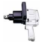
Гайковерт пневматический 1 1/2"DR, 7000 об/мин 780 Нм
