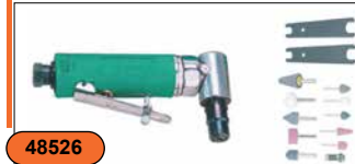
Бормашинка пневматическая, 155 мм угловая с насадками, патрон 6 мм, 18000 об./мин., 85 л/м, набор
