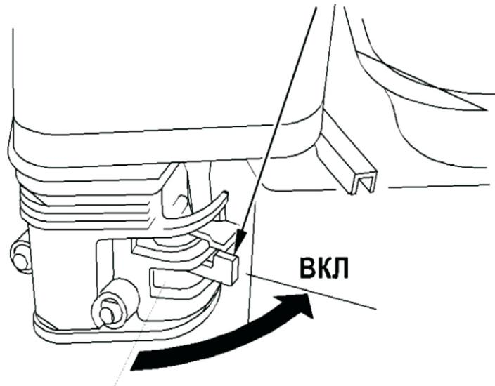
3. Если двигатель холодный, установите рычаг воздушной заслонки в положение «ЗАКРЫТО». Если производится повторный запуск прогретого двигателя, оставьте рычаг воздушной заслонки в положение «ОТКРЫТО».
