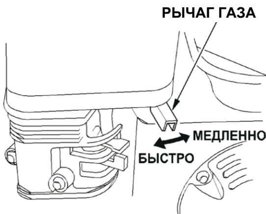
В зависимости от положения рычага двигатель работает быстрее или медленнее. Мощность насоса регулируется рычагом газа. Увеличение скорости работы двигателя ведет к увеличению мощности насоса.
