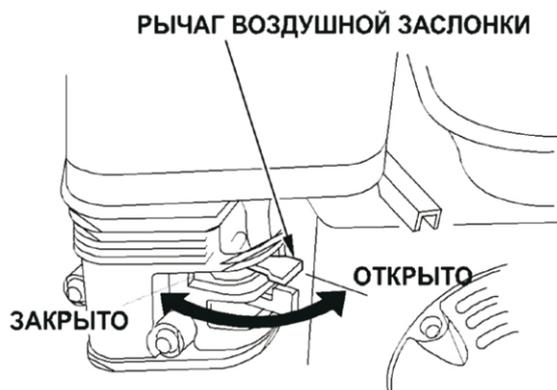
В положении «закрыто» топливно-воздушная смесь обогащается. Это позволяет запустить «холодный» двигатель.
