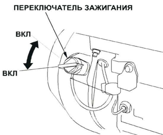
Если Вы установите переключатель зажигания в положение «ВЫКЛ», то двигатель остановится.
