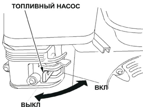
Перед запуском двигателя следует установить топливный кран в положение «ВКЛ».
