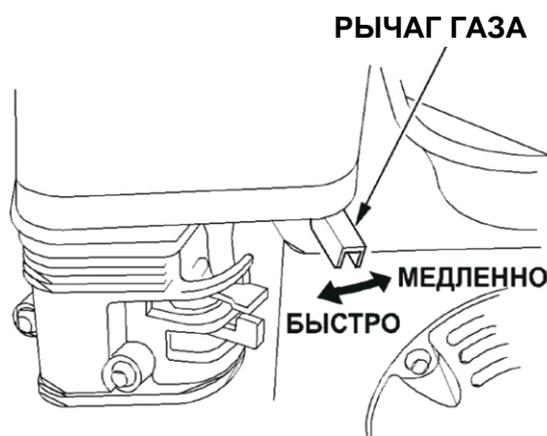
В зависимости от положения рычага двигатель работает быстрее или медленнее. Мощность насоса регулируется рычагом газа. Увеличение скорости работы двигателя ведет к увеличению мощности насоса.
