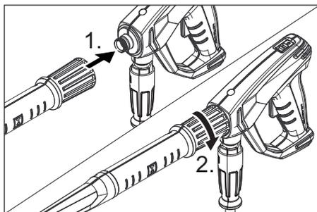
→ Monter dysen på strålerøret (markering på positioneringsringen oppe), og spænd den fast med hånden.
