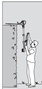
Висока горизонтальна стрижка: Блок мотора установлено під кутом – 75°, телескопічна трубка висунута
