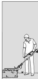
Низька стрижка: Блок мотора установлено під кутом – 60°, телескопічна трубка висунута
