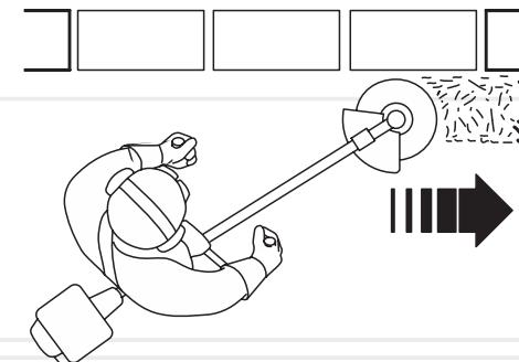
При скошуванні трави на ділянках, які прилягають до огорож, парканів, кам'яних стін та фундаментів, електрокосу ведіть дуже повільно в напрямку, як зображеного на малюнку, намагаючись зрізати траву якнайближче до перешкод. При цьому намагайтесь, щоб ліска не торкалася до цих перешкод, оскільки може відбутися обрив ліски.
