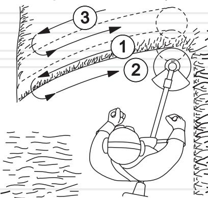
При скошуванні ділянок, на яких відсутні перешкоди, поступово ведіть електрокосу з боку в бік, намагаючись при цьому утримувати ріжучу частину виробу на одній висоті від землі. Для визначення бажаної висоти скошування, здійсніть пробне скошування. При скошуванні широких ділянок, поділіть зону роботи на сектори.
