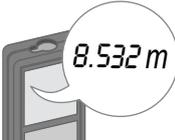
**i** Целевые поверхности: Ошибки при измерениях могут возникнуть в случае выполнения измерений до таких поверхностей, как бесцветные жидкости, стекло, стирфом, матовые полупроницаемые поверхности или при наведении на очень блестящие поверхности. При наведении на темные поверхности время измерения увеличивается.
