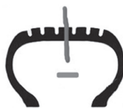
Неправильне встановлення джгута
