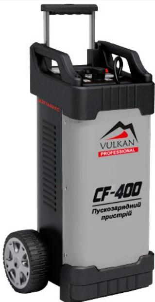
Пускозарядний пристрій Vulkan CF400 призначений для зарядки акумуляторних батарей напругою 12-24В та ємністю до 500Ah, також для запуску двигунів транспортних засобів сумісно з акумуляторною батареєю напругою 12В або 24В. Запуск двигунів проводиться за допомогою короткочасної подачі струму до 500А.
