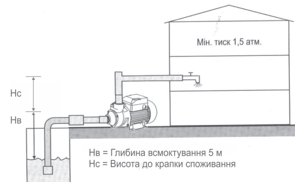
Мал. 1. Типові схеми водопостачання з використанням відцентрового поверхневого насоса.
