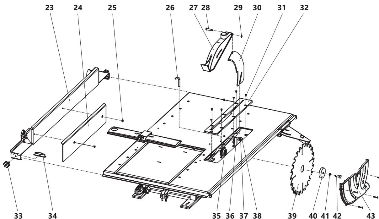
Рисунок 5. Схема сборки станка на операцию пиления
