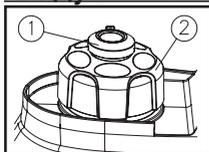
Крышка топливного бака ② обеспечена воздушным клапаном. ① Воздушный клапан должен быть выставлен на «ВКЛ.». Это позволит горючему поступать в карбюратор.
