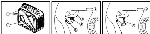
1. Открутите винты ①, снимите декоративную крышку ②, слейте топливо ③
