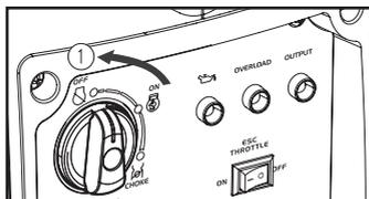
1. Установите поворотный выключатель в положение “ВЫКЛ” ①
