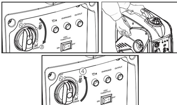
1. Поверните переключатель ESC в положение «ВЫКЛ.» ①.
