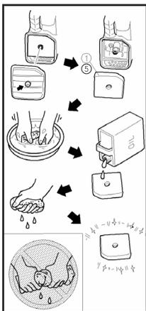
1. Выкрутите винты ① и снимите декоративную крышку ②
