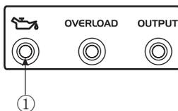
Сигнальная лампа уровня масла ① загорается, после чего двигатель автоматически останавливается. Он не запустится, пока не будет заполнен резервуар масла.
