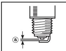
**СОВЕТ:** Зазор свечи должен измеряться свечным щупом и при необходимости корректироваться согласно спецификации.
