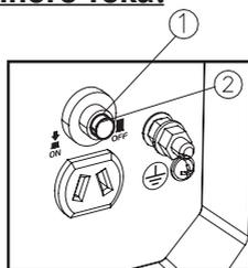
Предохранитель постоянного тока автоматически переключается на «ВЫКЛ.» ②, когда элек-
