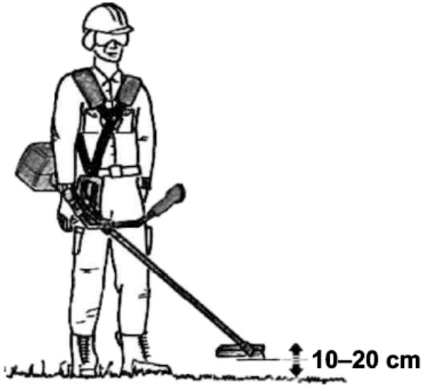
Рисунок 7. Регулювання наплічного паскового підвісу.
