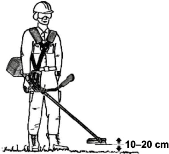
Рисунок 7. Регулювання наплічного паскового підвісу.
