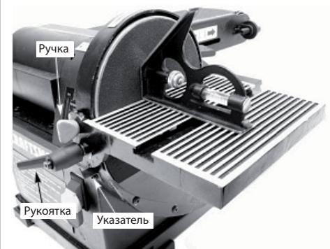
Рис. 5 Використовування столу з кругом
