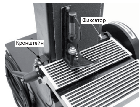
Рис. 6 Використовування столу зі стрічковим вузлом
