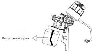
б) Если направление распыления вниз, загнутый конец трубки следует направить к передней стенке бачка.
