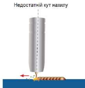
Недостатній кут нахилу Збільшене розбризкування металу, погіршений контроль зварювання
