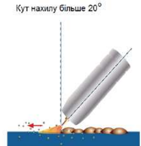
Кут нахилу більше 20^\circ Велике розбризкування, поганий контроль зварювання та погане проплавлення, нестабільна дуга
