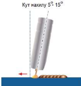
Кут нахилу 5^\circ - 15^\circ Відмінне формування шва, гарний контроль зварювання
