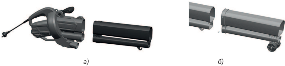
Рисунок 2. Схема підготовки повітряного тракту виробу до роботи.
