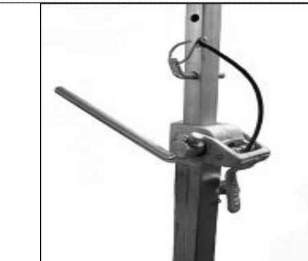
Установите стойку в место сверления. Установите быстросъемное крепление на основание стойки как можно ближе к направляющим регулировки угла наклона. Закрепите стойку поворачивая ручку (G) быстросъемного крепления по часовой стрелке, и зафиксируйте шпилькой (H).
