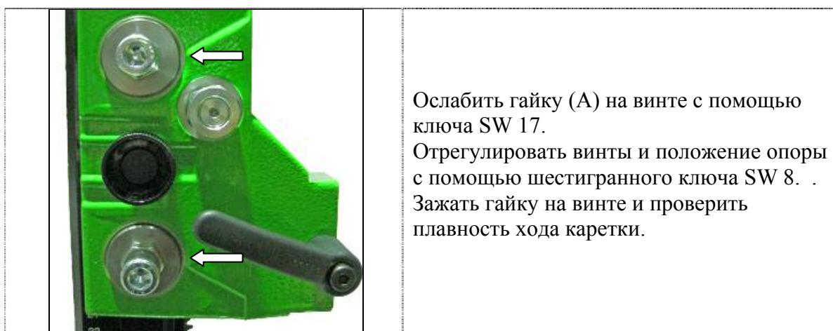
Ослабить гайку (A) на винте с помощью ключа SW 17.
