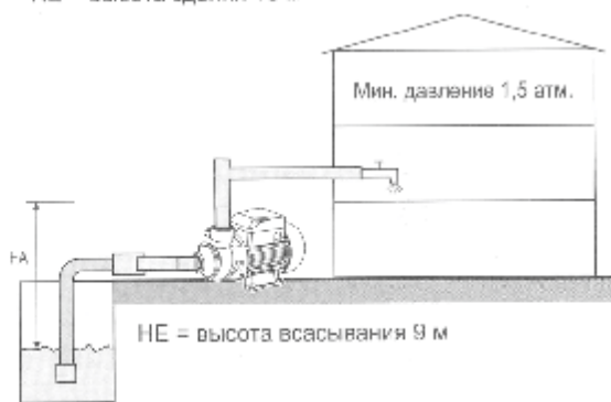
Рис. 1. Типовые схемы водоснабжения с использованием центробежного моноблочного насоса.
